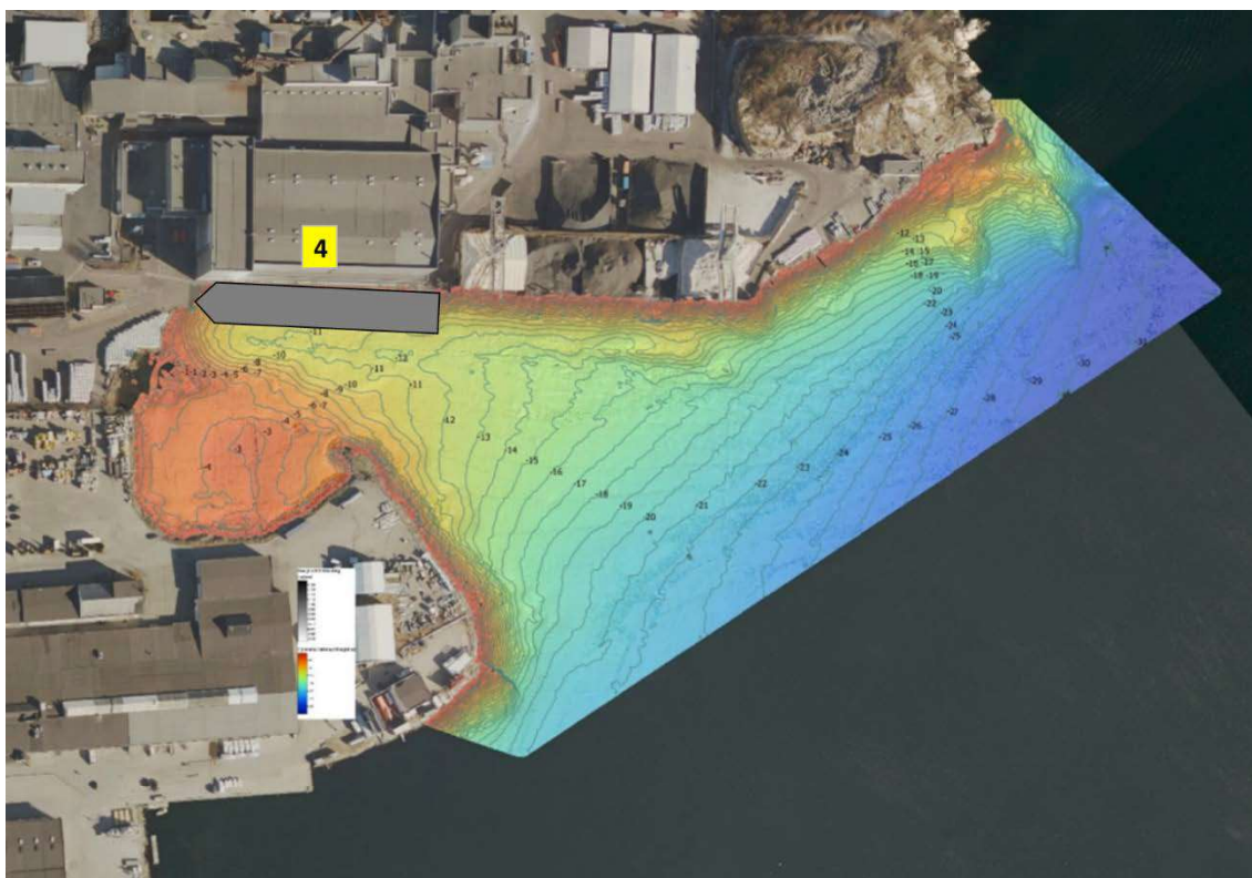
Figur 12. Omtrentlig plassering av båter som lossere eller laster i posisjon 4. Båten på figuren er omtrent 100 m lang. Noen av båtene i posisjonen bakker til kai, og det modelleres for to scenarier ved oppstart fra kai. Blå farge utgjør de dype områdene. Tiltaksområdet utgjøres av dybder mindre enn 20 m (merket med turkis, grønn, gul og rødt), med unntak av kaikonstruksjoner og grunne til venstre i figuren.
