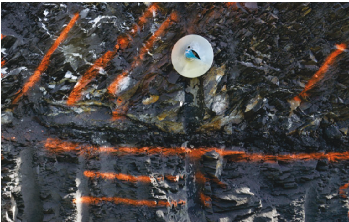
Figur 9. Eksempel på diskordans. Orientering til lagdeling er markert med oransje spray
