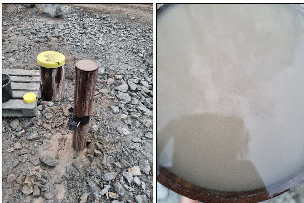
Figur 4-8: Ny måling av vannmengde 15. desember. Vannet var grumsete med partikler, lys brun i fargen. Strømmet jevnt over rørkanten, men med ca. 10 % høyere rate enn for gårdsdagen, tilsvarende ca. 0,61 liter/min.
