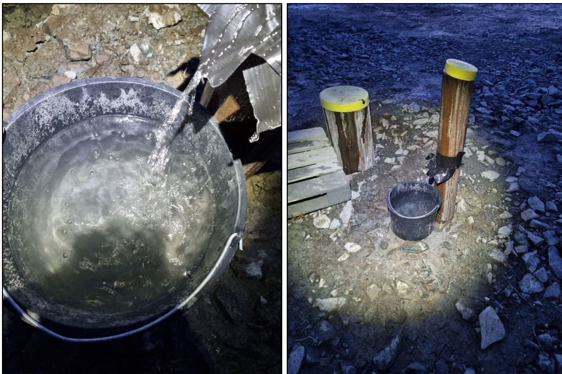
Figur 4-7: Måling av vannmengde 14. desember. Målt fra topp av pel med 12 liters murerbøtte og provisorisk trakt. Vannet var klart i fargen og strømmet jevnt over rørkanten. Fylte bøtte a 12 liter på ca. 22 minutter tilsvarer ca. 0,55 liter/min.
