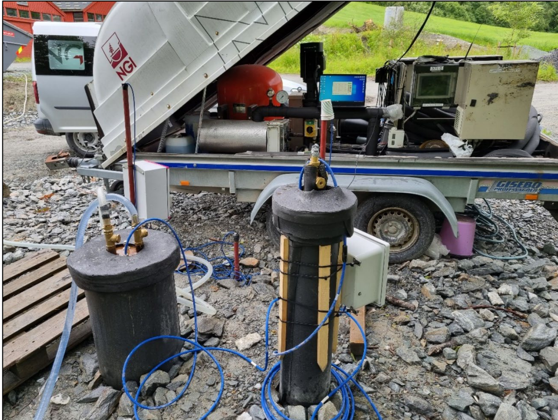
Figur 4-12: Klargjøring av pelene for TRT-testing sommeren 2022.
