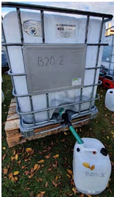
Figur 5 Oppsett for kontainerforsøk. Toppen av kontainerne er kuttet av, og regnet renner fritt gjennom steinmassene i kontaineren, og ut i slangen til dunken på utsiden. Vannet i dunken samles inn til analyser.
