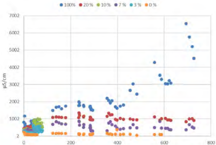
Figur 16 Ledningsevne (konduktivitet) målt for kolonnene satt opp av NGI med ulik blanding av alunskifer og rombeoporfyrr. Andel alunskifer i en kolonne angis i tegnforklaringen.
