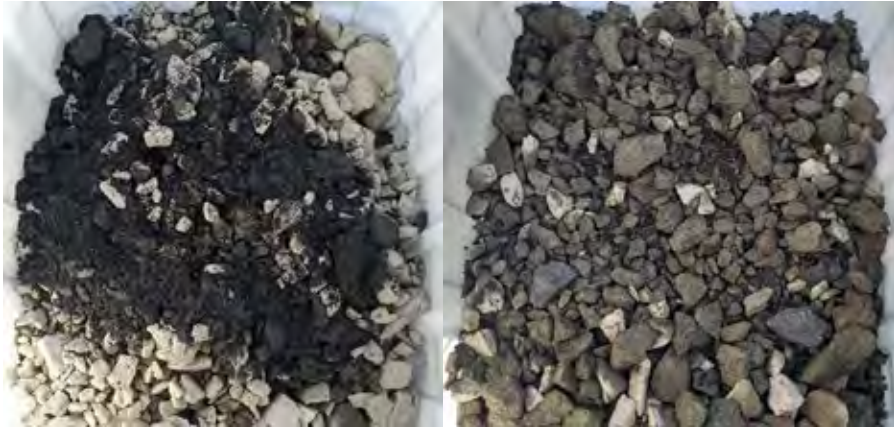
Figur 6 Innholdet i kontainer B5_1 (5 % alunskifer og 95 % rombeporfyr før (venstre) og etter (høyre) blanding av massene.
