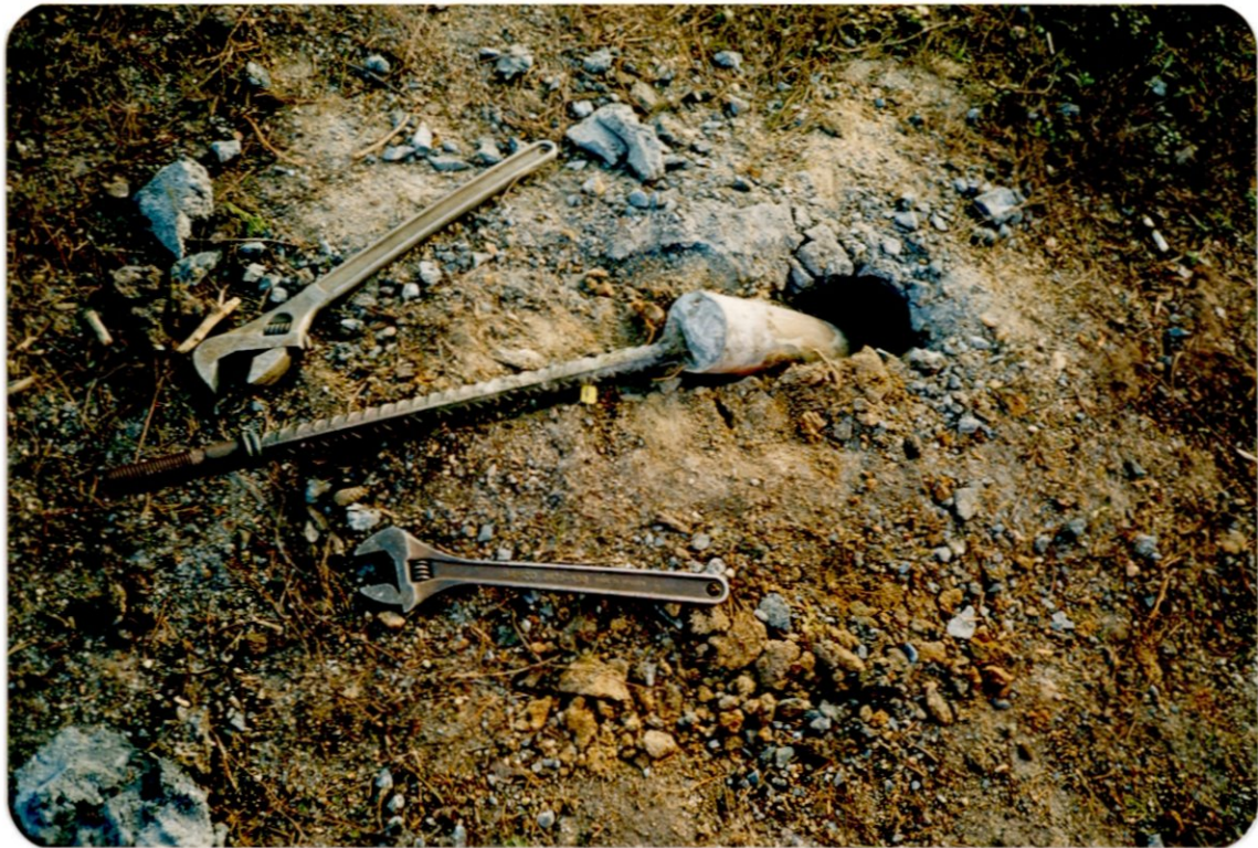
Foto 9 Illustrasjon av nedskjæring av pel i bakken ved radiell belastning
