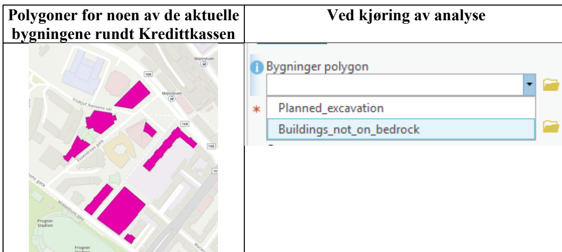
Figur 13: Bygningspolygonene er her navngitt "Buildings_not_on_bedrock". Det er valgt å utelukke bygninger fundamentert på berg, samt å kun ta med de nærmeste bygningene.
