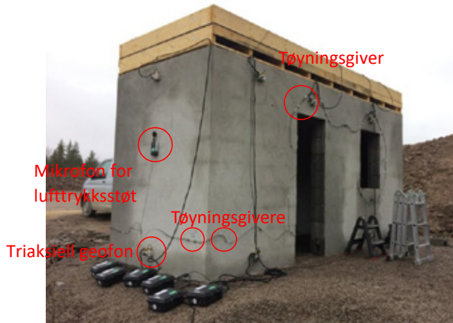
Figur 5. Instrumentering av Lecabygget
